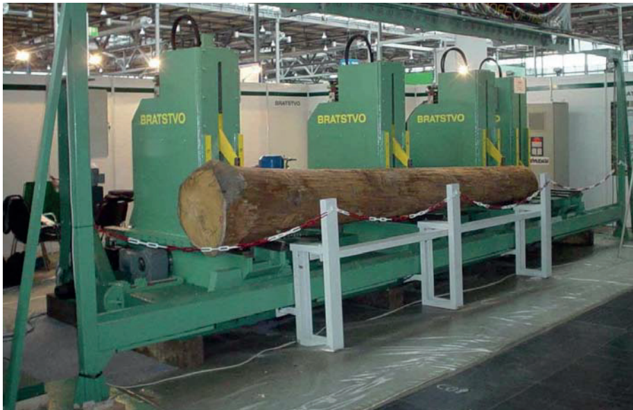
сл. Уред за поставување и поместување на трупци кај тешки лентовидни пили
