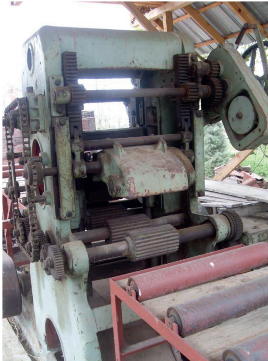
сл. Гатер со ширина на рамот до 550 mm
