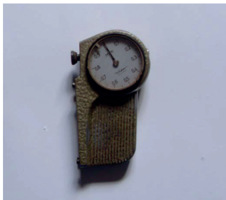
сл. Инструмент за мерење на отклонот на забите
